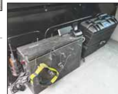
▲ Her sees ladestasjon til venstre og operativ leder-koffert med PC, papirer, kabler og prosjektor til høyre. Inni ladestasjonen er omformeren. Kontaktene på venstre siden er 12v sigaretttenner uttak og 5v USB. På høyre side er det 230v kontakter til PC, VHF, samt flere 5V USB kontakter.
